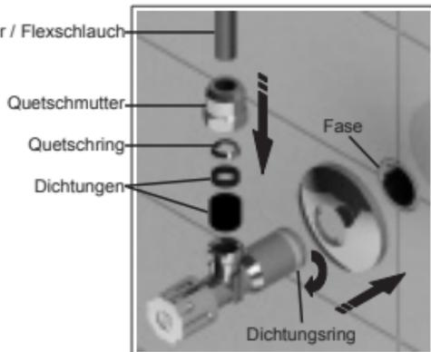
Kupferrohr / Flexschlauch bis zum Anschlag durch die Quetschverschraubung drücken und mit dem Gabelschlüssel festziehen.
