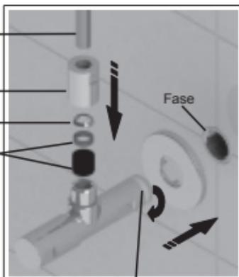
Kupferrohr / Flexschlauch bis zum Anschlag durch die Quetschverschraubung drücken und mit dem Gabelschlüssel festziehen.
