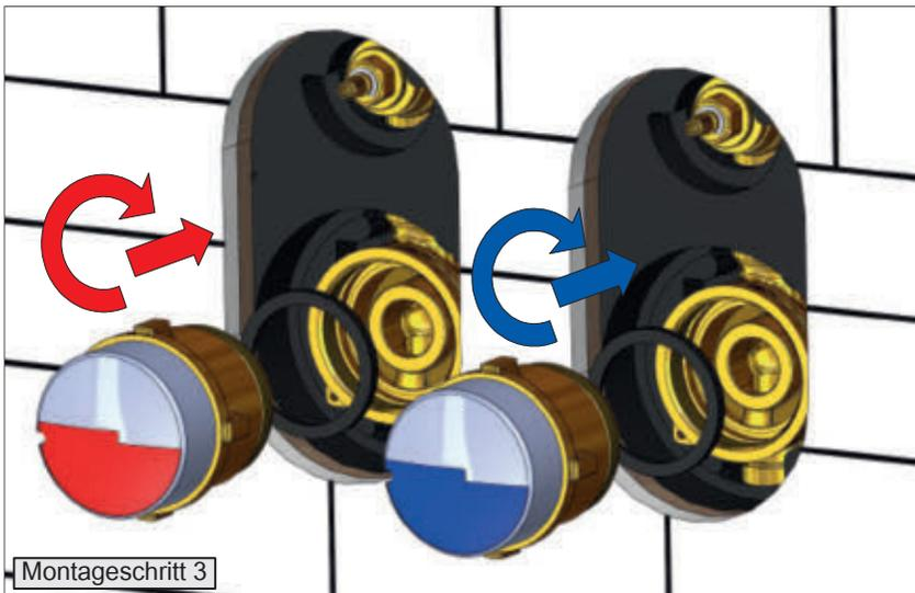
**!!! ANSCHLIEßEND DICHTIGKEITSPRÜFUNG DURCHFÜHREN !!!**
