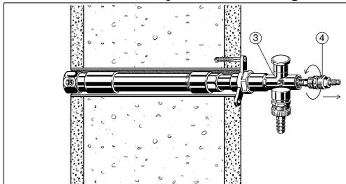
2. Neue Ventilspindel (1) mit Spindelgewinde (2) komplett in die Armatur einschrauben, bis diese geschlossen ist.
