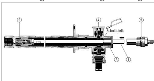
6. Spindeloberteil (5) auf die Ventilspindel (1) aufstecken und komplett in die Armatur einschrauben.
